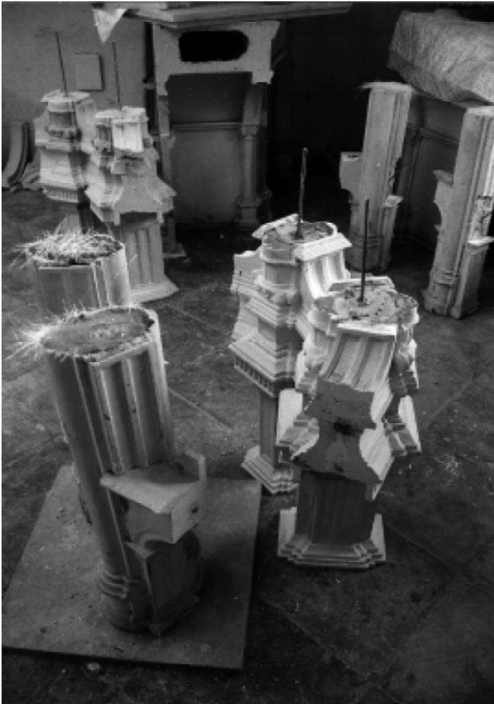
Unión de columnas mediante varilla de acero y fibra de vidrio
